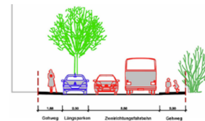
Querschnittsgestaltung Südwall mit Bäumen für den "Grünen Wall" und breiterem Gehweg. Darstellung oben mit Begegnungsverkehr; unten mit Überholen eines Fahrradfahrers.
